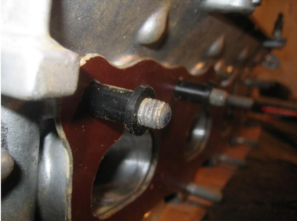
Löcher an der Ansaugbrücke auf 10mm aufgebohrt für die Hülsen
