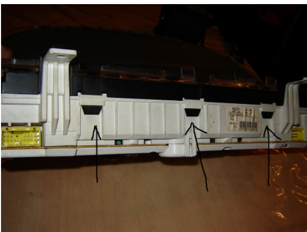
Die beiden gelben äußeren Stecker ziehen. Dann ist der Tacho draussen, weiter wie im Bild, den Plexiglasdeckel entfernen (auf der Oberseite auch!)
