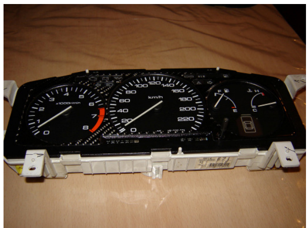
Die Abdeckung (hier in Carbon) abziehen
