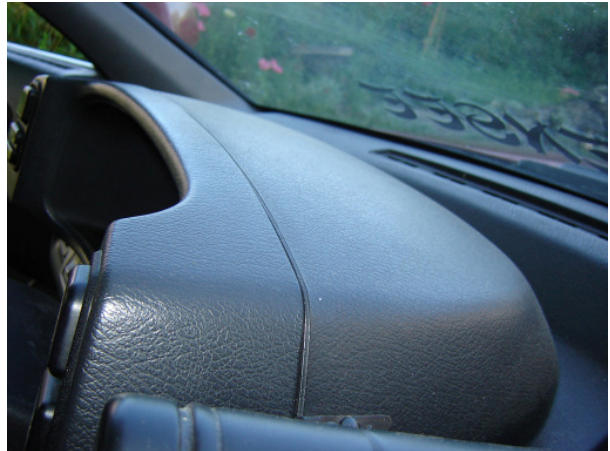
Den vorderen Teil der Blende nach vorn hin runterziehen und die Stecker der Schalter abziehen
